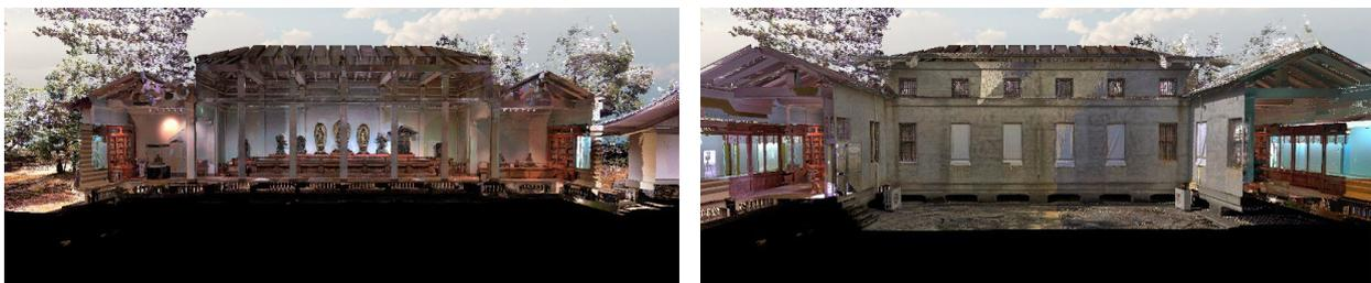
図7 点群データを用いた展示コンテンツ事例（観覧者の操作により、視点位置や断面位置を自由に移動し、専門的知識や技能によらない空間構成の直観的把握を可能にする）
